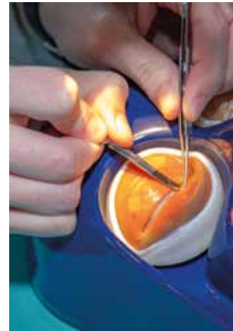
Die 3D-gedruckten Augenlid-Modelle sollen so realitätsnah wie möglich sein. Dafür sind circa 400 Materialmischungen notwendig.
